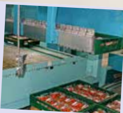
Vollautomatisch werden die Erdbeerschalen in Kisten gepackt, die anschließend maschinell auf Paletten gesetzt werden
