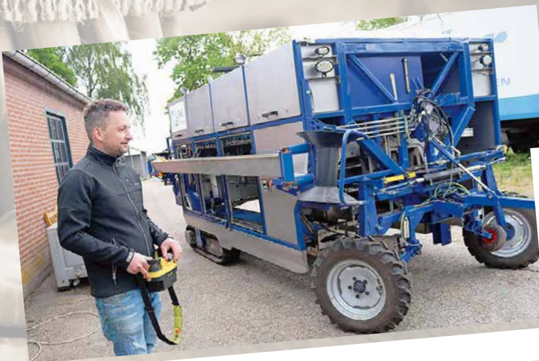
Arno van Lankveld führte auf der Hofffläche die Wendigkeit des von ihm entwickelten Prototypen zur vollautomatischen, selektiven Spargelernte vor
