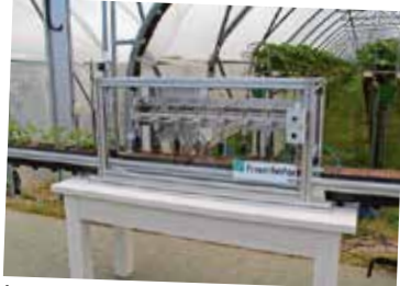
Auch bei der Bepflanzung kommt Robotertechnik zum Einsatz. Durch das automatische Stanzen der Löcher wird der Pflanzvorgang erheblich vereinfacht und die Arbeitszeit um ca. 50 % reduziert
