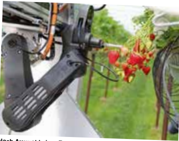
Nach Auswahl einer Frucht führt der Roboter seinen Arm aus, durchtrennt mit einer Schere den Stängel, hält die Frucht fest und legt sie in eine Schale
