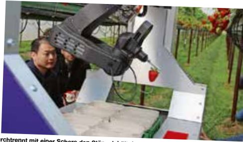
Nach Auswahl einer Frucht führt der Roboter seinen Arm aus, durchtrennt mit einer Schere den Stängel, hält die Frucht fest und legt sie in eine Schale
