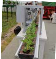
Auch bei der Bepflanzung kommt Robotertechnik zum Einsatz. Durch das automatische Stanzen der Löcher wird der Pflanzvorgang erheblich vereinfacht und die Arbeitszeit um ca. 50 % reduziert
